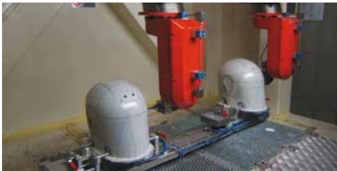
Taglio in simultanea di 2 caschi. Materiale: fibra di vetro
