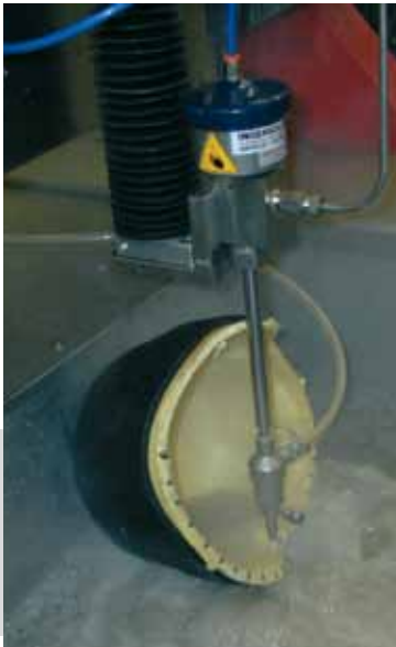
Particolare taglio elmetto. Materiale: kevlar
