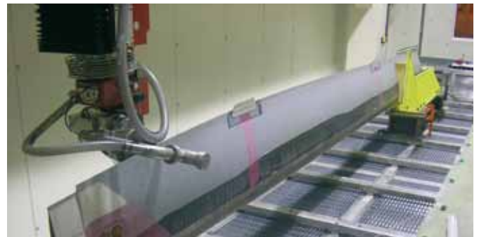
Taglio 5 assi con abrasivo e catturatore pala di elicottero. Materiale: kevlar/titanio/fibra di carbonio
