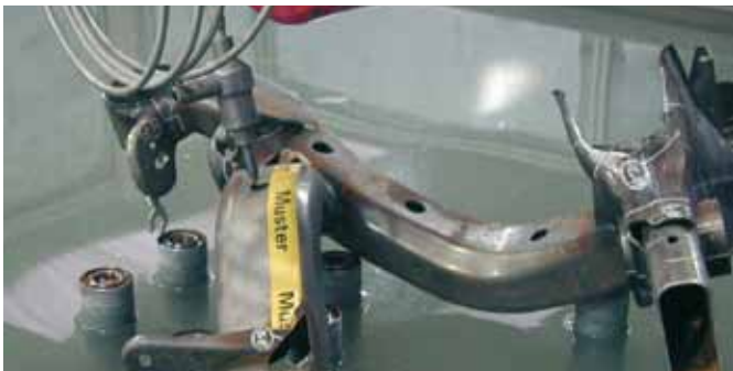
Taglio assale auto 5 assi. Materiale: acciaio inox Spessore: 5 mm
