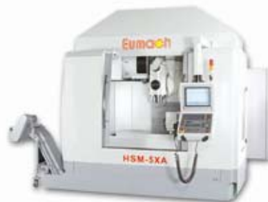
HSM-5X 1020 / 610 / 810MM, BT#40, 14000RPM
