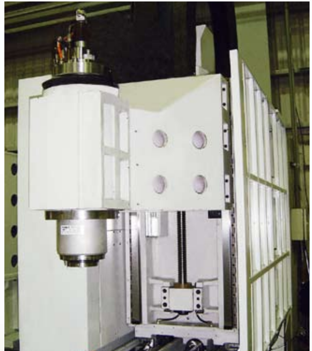
HSK-A63 taper 14000 / 18000 / 24000 / 30000RPM HSK-A100 taper 10000 / 12000 / 15000RPM
