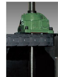
▲ Crossrail Hoist Motor
