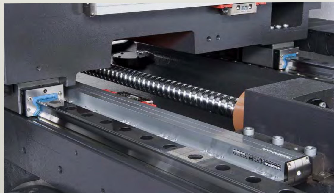
Optional 3 Axes Linear Scales OP
